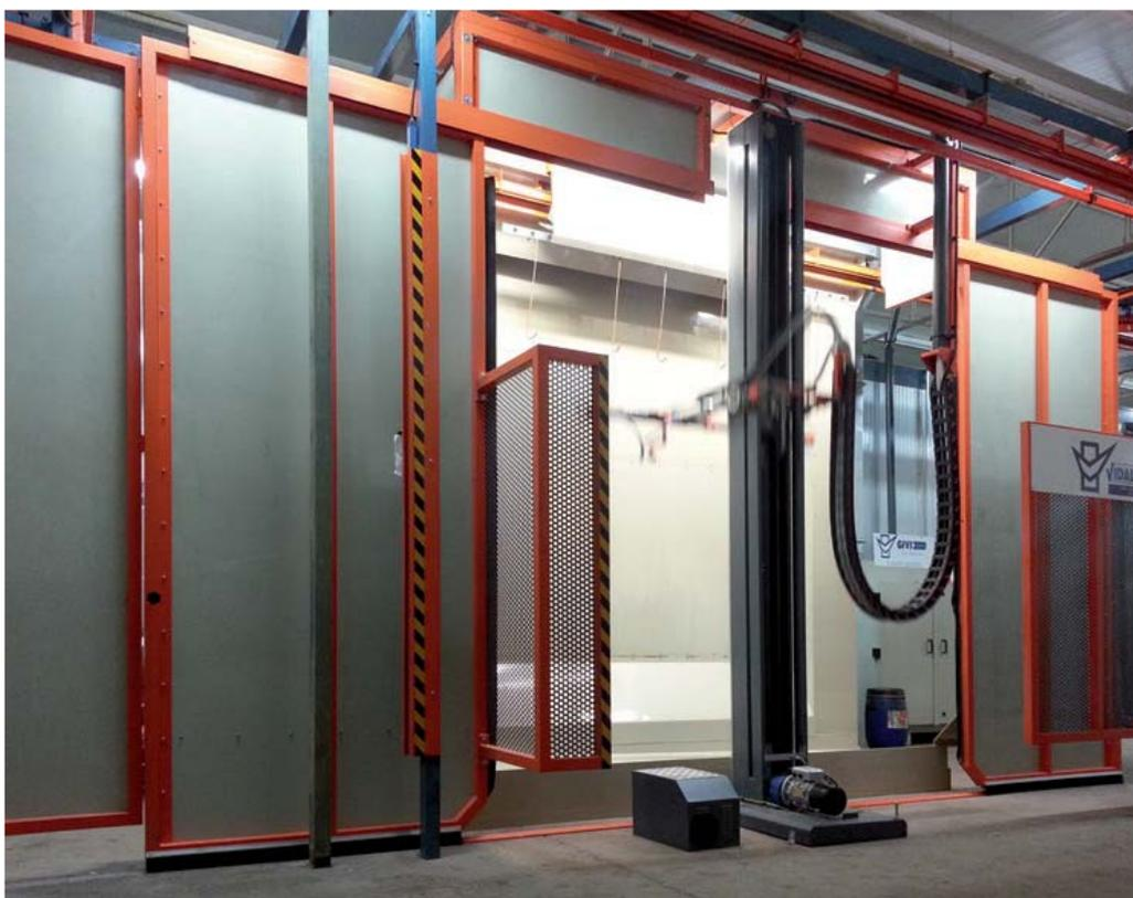
12 - L'apertura della parte frontale della cabina *GIVI 3000 Plastic* che facilita le operazioni di pulizia interna della macchina.
