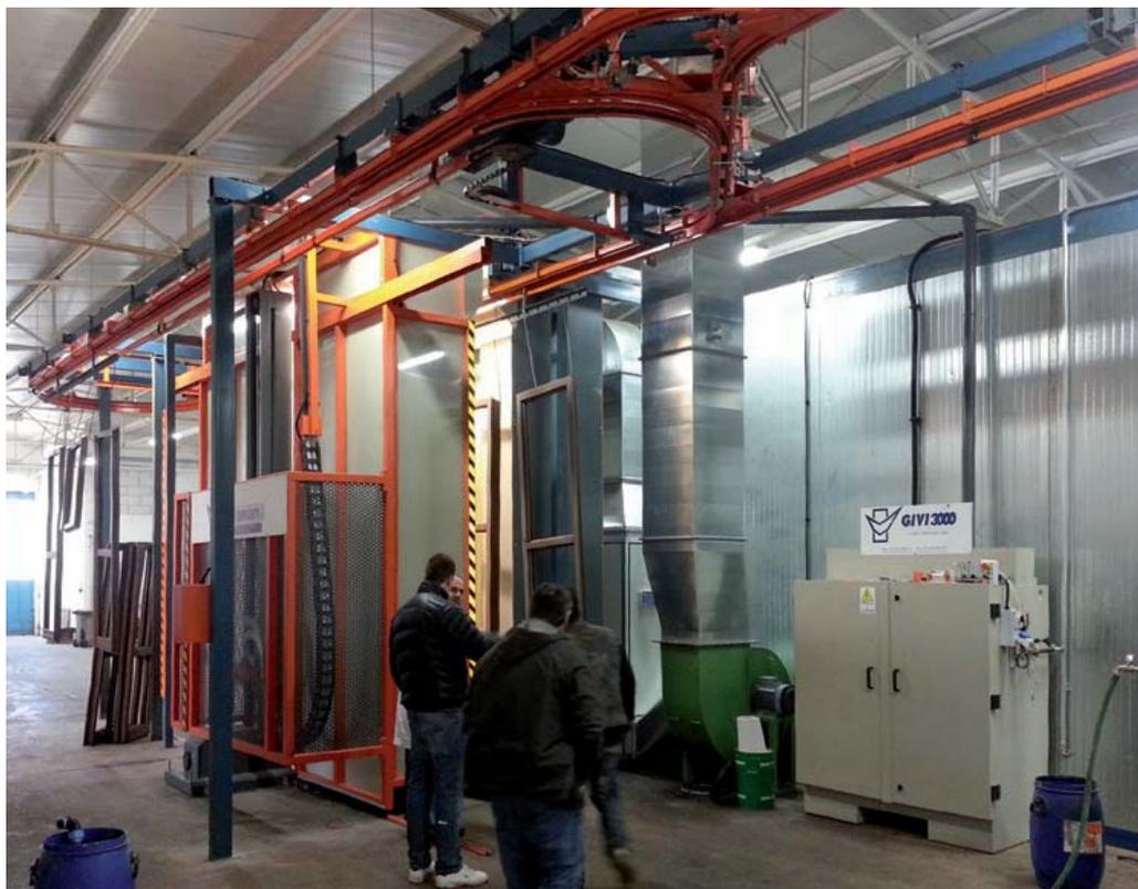
7 – Il tunnel dell'impianto *GIVI 3000 Plastic* per l'applicazione della finitura.
